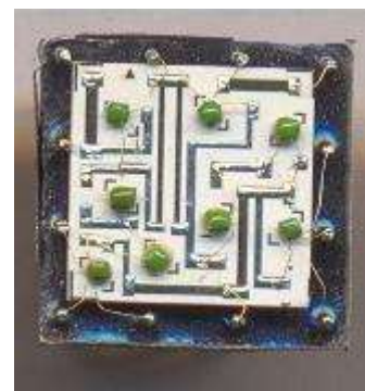
Микросхемы серии 217, выполненные на тонких пленках, 1970-е годы
