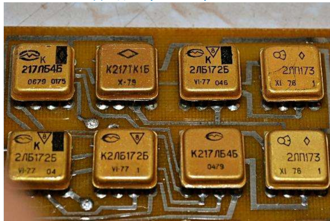
Микросхемы серии 217, выполненные на тонких пленках, 1970-е годы
